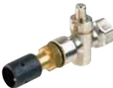
Prüfbrenner rückzündsicher zur Entlüftung der Gasstrecke. Stehender Einbau erforderlich. Ein Druckknopfahh ist vorzuschalten, wie auf der Abbildung zu sehen. (Druckknopfahh ist separat zu bestellen)
