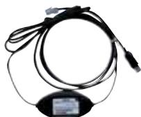
Ein Adapter mit Software zum Anschluss an PC steht zur Verfügung, um Diagnose-Daten aus dem Steuergerät zu lesen.
