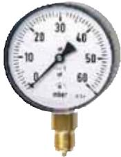
Kapselfederanometer mit Stahlblechgehäuse 100 mm Durchmesser schwarz. Genauigkeitsklasse 1,6 gemäß EN 837-3/6, überlastsicher bis 1,3 x Skalenendwert. Zur Vermeidung ständiger Druckbelastung ist jeweils ein Druckknopfahh vorzuschalten.
